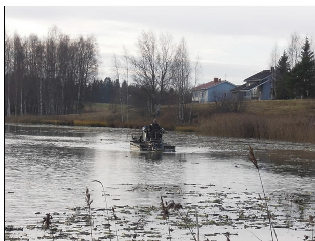
Kuva 10.2. Mikkolanlammen niitto ja juurakoiden poisto tehtiin Truxor-laitteistolla.
